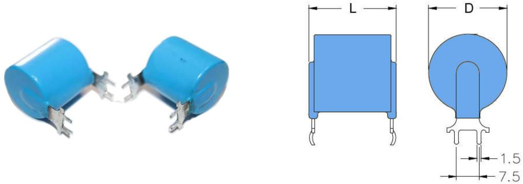
SD 系列复合陶瓷电阻针对 PCB 板设计，100%有效体积，过载能力超强，不失效，无电感，体积小。在开关电源等各类电源限流、电容器充放电应用上有独特优势，是电动汽车、变频器启动电阻的最佳选择。
